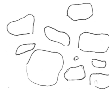
CALADE JOINT ESPACÉ CIMENTÉ
